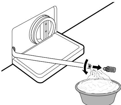
**4** Медленно отверните фильтр сливного насоса, чтобы слить остатки воды, а затем удалите все загрязнения и посторонние предметы из фильтра.
