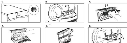
1) При необходимости почистите фильтр щеткой в теплой воде или очистите его при помощи пылесоса.
