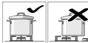
Umieszczać naczynie na palniku w położeniu dokładnie centrycznym. W przeciwnym razie może się ono wyrzucić. Nie stawiać dużych naczyń na palnikach blisko pokręteł. Może to spowodować uszkodzenie pokręteł na skutek wysokiej temperatury.
