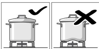
Nie należy używać odkształconych naczyń, które stoją w sposób niestabilny na płycie kuchenki i mogą się przewrócić. Należy stosować wyłącznie naczynia o płaskim i grubym dnie.
