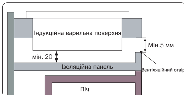
Встановлення варильної поверхні_63
